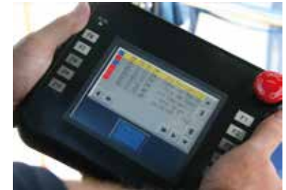
Sistema de control remoto de una pasarela de acceso para pasajeros.
