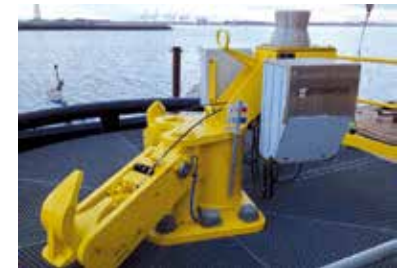
Instalación de un Gancho de Escape Rápido en el puerto.
