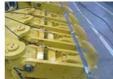
Sensor de carga instalado en un gancho de escape rápido.
