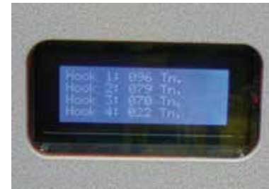
Control de carga de cada uña desde el centro de control y también, desde el propio gancho.
